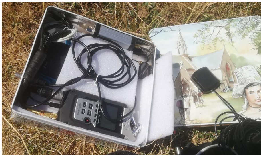
Figure 15 Système alimenté sur batterie 5V pour d'enregistrement numérique signal ELF/VLF (HN4pro voie 1) et signal de sortie GPSDO 5KHz (HN4Pro voie 2)
